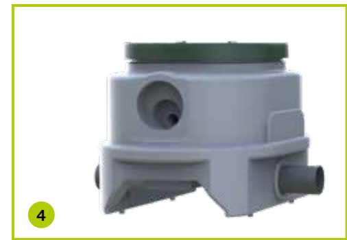
Répartiteur externe d'alimentation (2/3V, à auget basculant) Perte de fil d'eau du répartiteur : 240 mm
